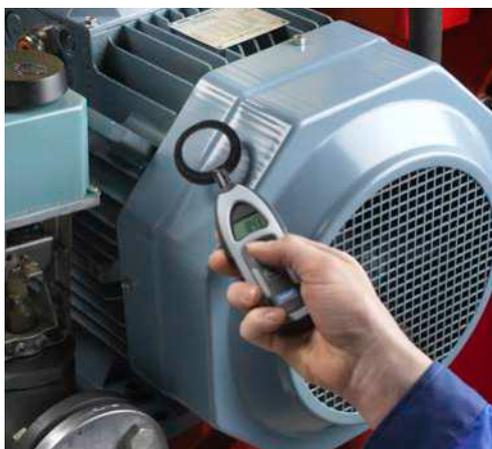
Los motores eléctricos son más susceptibles de sufrir erosión eléctrica en los rodamientos cuando están controlados por un accionamiento de frecuencia variable. El EDD Pen, incorporado a un programa de mantenimiento predictivo, puede ayudar a detectar los rodamientos más propensos a fallar y, en gran medida, prevenir la parada no planificada de las máquinas.
