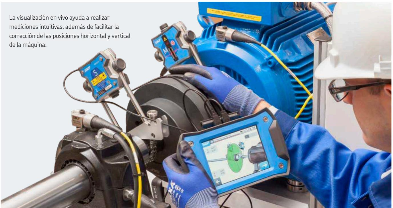
El avanzado sistema de alineación de ejes por láser con mejores capacidades de medición y de creación de informes
