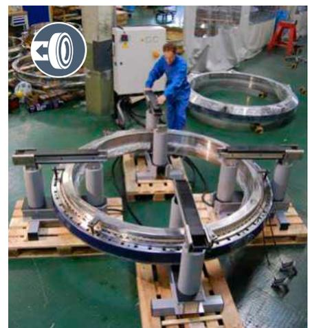
SKF tiene la capacidad para configurar el tipo de calentador serie TIH MC requerido, según la aplicación. Para obtener más información, comuníquese con su distribuidor autorizado SKF.
