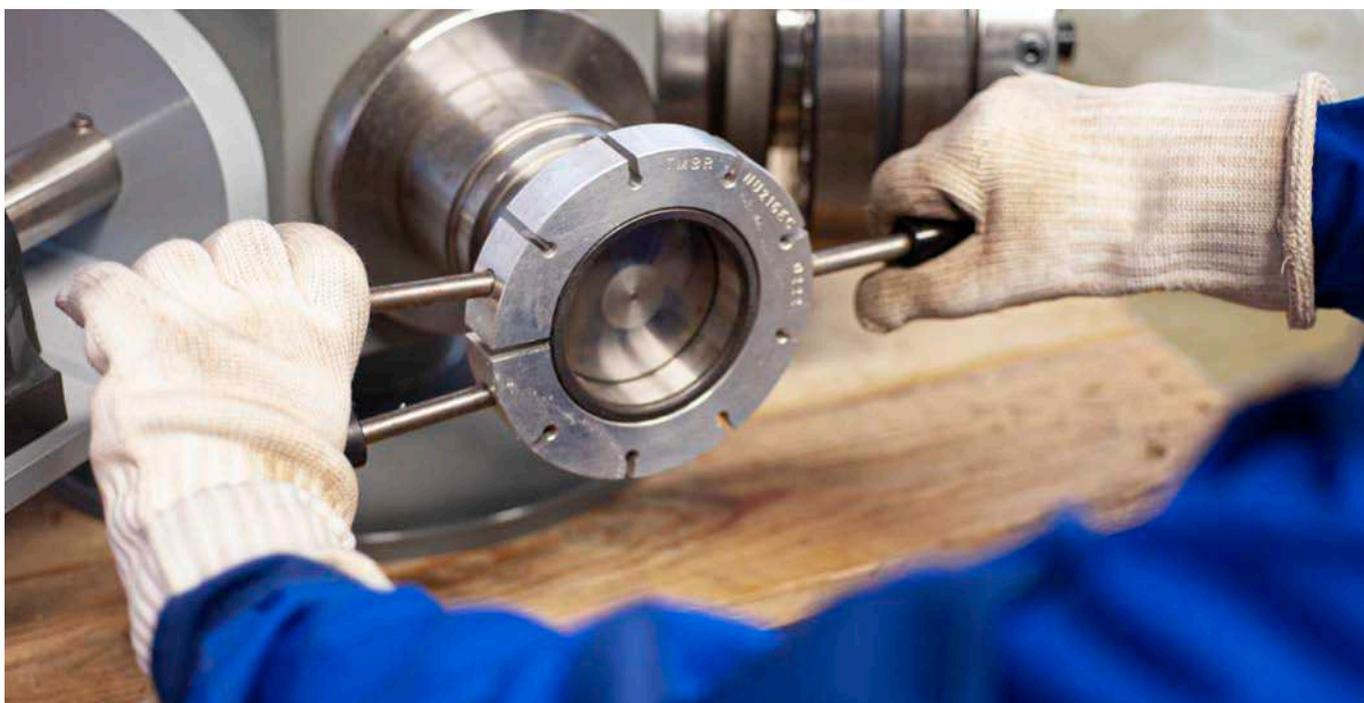
Los aros de calentamiento de aluminio SKF serie TMBR se fabrican para ajustarse con precisión a un aro de rodamiento específico. Las listas con los detalles de pedido facilitan la búsqueda del TMBR adecuado para una determinada designación de rodamiento.
