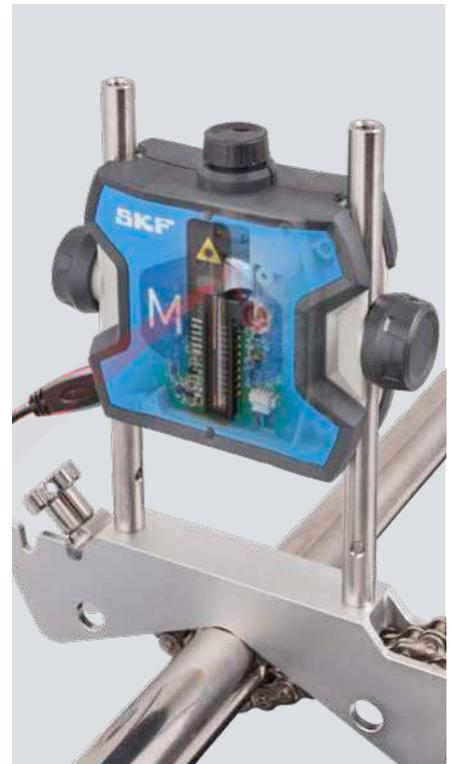
La visualización en vivo ayuda a realizar mediciones intuitivas, además de facilitar la corrección de las posiciones horizontal y vertical de la máquina.
