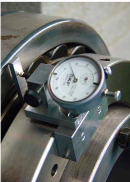
Para utilizar con las tuercas hidráulicas SKF HMV(C) de la generación anterior
