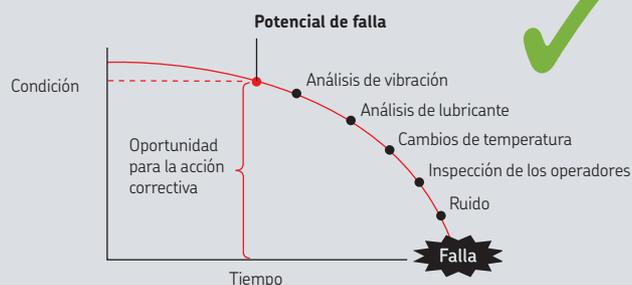
El mantenimiento basado en la condición significa que las reparaciones se realizan únicamente cuando es necesario.
