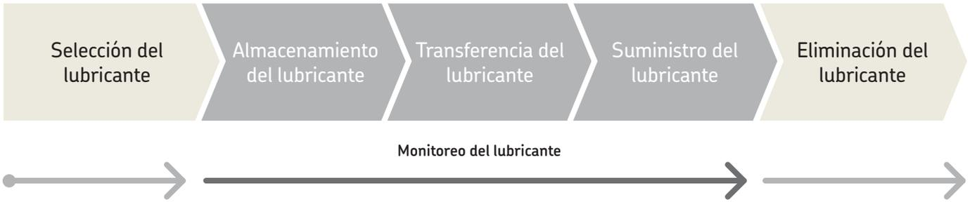
La selección de una grasa adecuada para un rodamiento en particular es un paso fundamental si el rodamiento debe cumplir las expectativas del diseño en su aplicación. Utilice SKF LubeSelect a fin de seleccionar el lubricante correcto para su aplicación.
