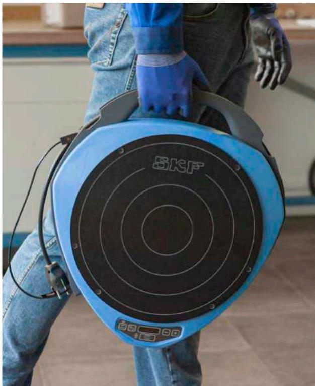
El TWIM 15, que utiliza energía eléctrica, se caracteriza por su estructura de fibra de vidrio y plástico resistente a altas temperaturas que permite lograr una baja diferencia de temperatura entre los aros interior y exterior del rodamiento. Esto ayuda a reducir las tensiones internas que se generan debido a la excesiva dilatación térmica del aro interior en comparación con el aro exterior.
