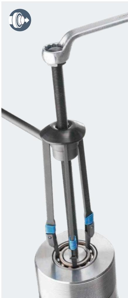
El diseño optimizado de las garras del extractor permite sujetar con firmeza el camino de rodadura exterior de los rodamientos SKF, sin necesidad de extraer la jaula del rodamiento.
