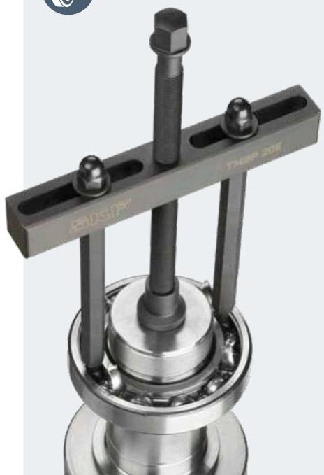
Extrae rodamientos sin necesidad de desmontar la máquina
